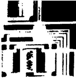
L'érosion a éliminé les pixels isolés sur le fond et a érodé le contour des objets de l'image *CIRCUIT*.
