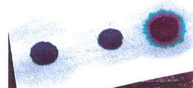
Auréole bleue apparaissant à la périphérie de la tache (fin de l'adsorption du bleu)
