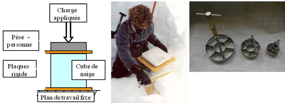
**Figure 49.** Essais permettant d'obtenir la résistance à la compression simple et la contrainte tangentielle de la neige (Burlet, 2002)
