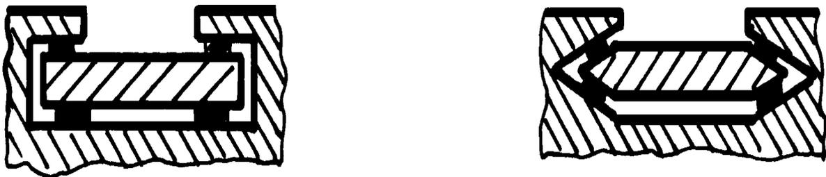
Fig. 20 – Butées hydrostatiques à double effet
